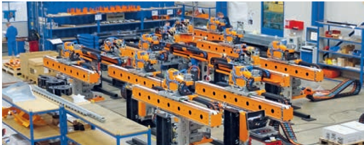
Vorinbetriebnahme des Compact-Transfers in Schloß Holte-Stukenbrock
