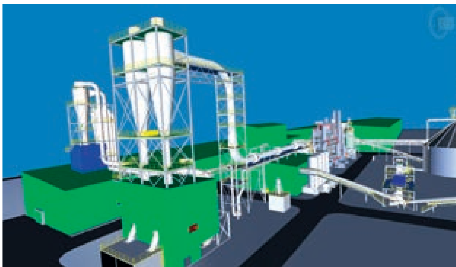
Pre-Engineering für die MDF-Anlage Asperbras/Brasilien
