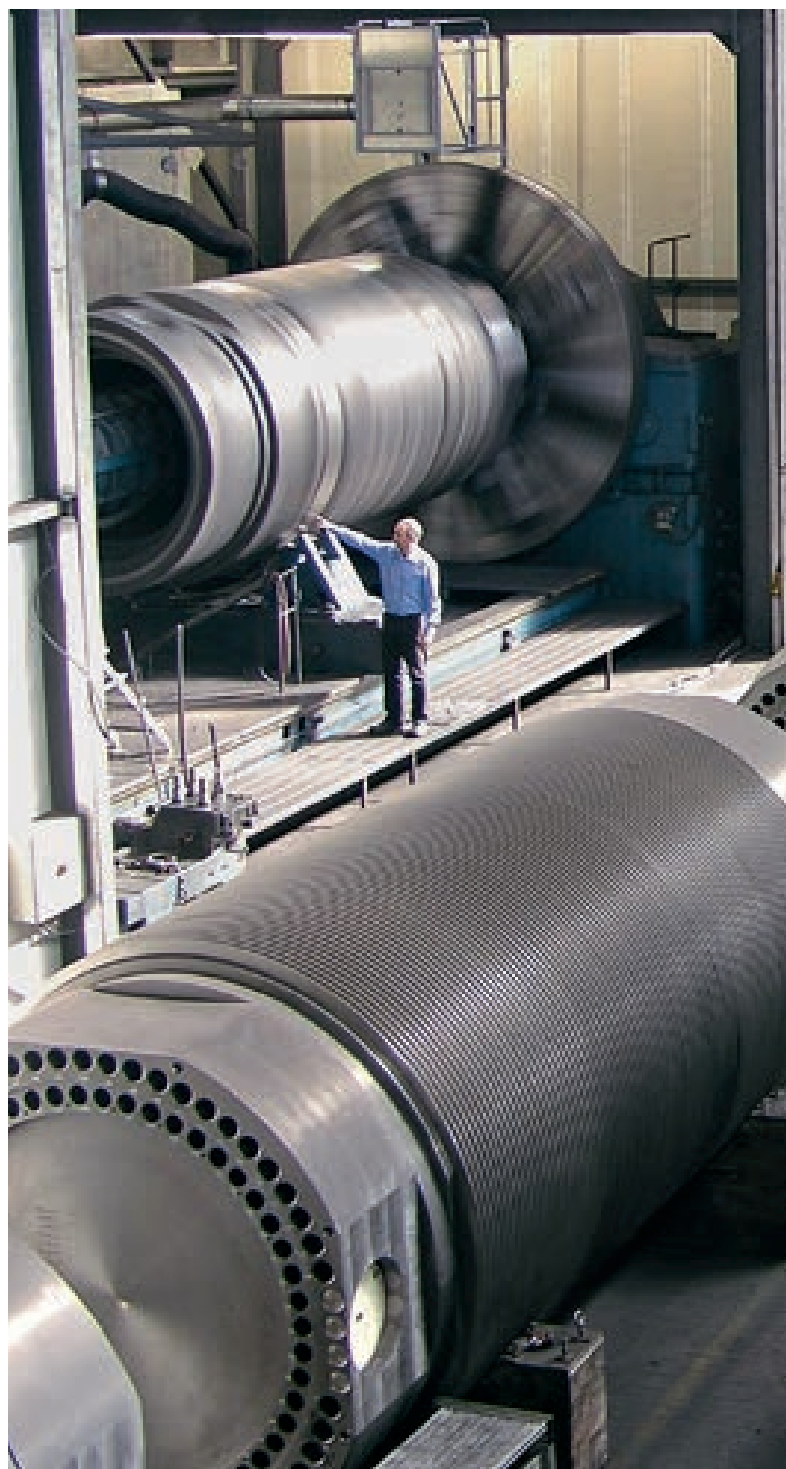
Fertigung von CASTOR®- Behälterkörpern
