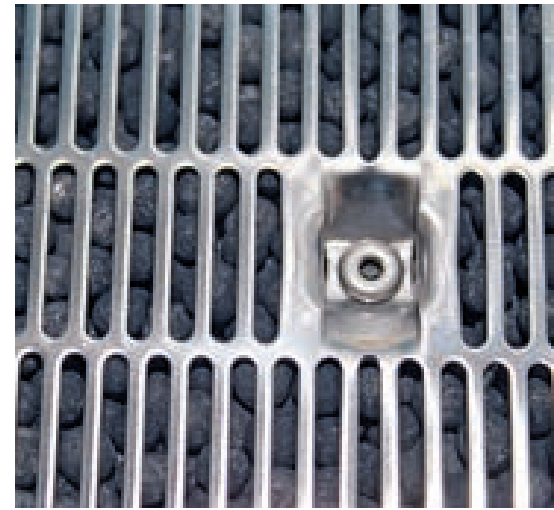
In eine Kassette gefülltes Katalysatormaterial
