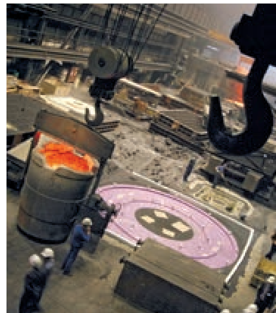
Gießgruben und Gussmodelle im Einsatz in der Handformerei
