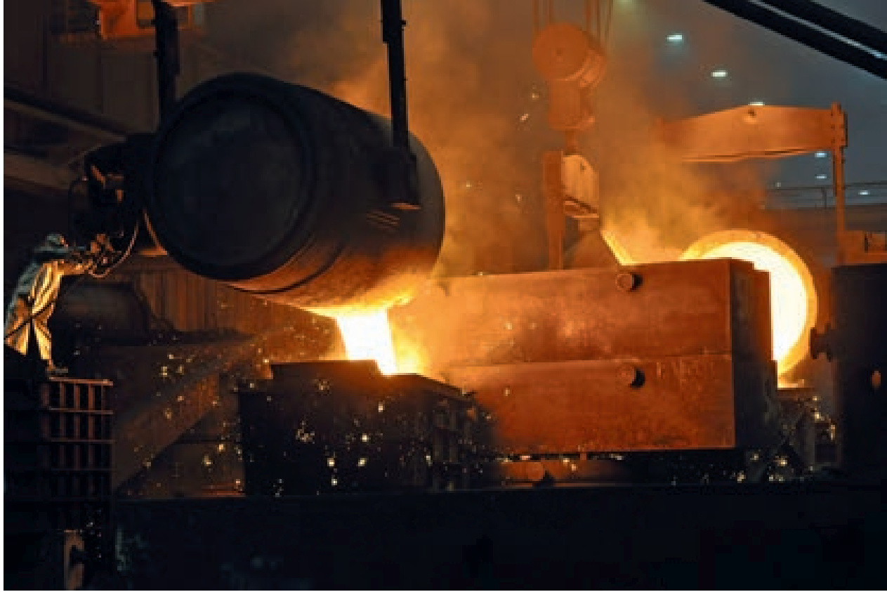
Abguss eines CASTOR®-Behälterkörpers mit einer Schmelzetemperatur von 1.320 °C
