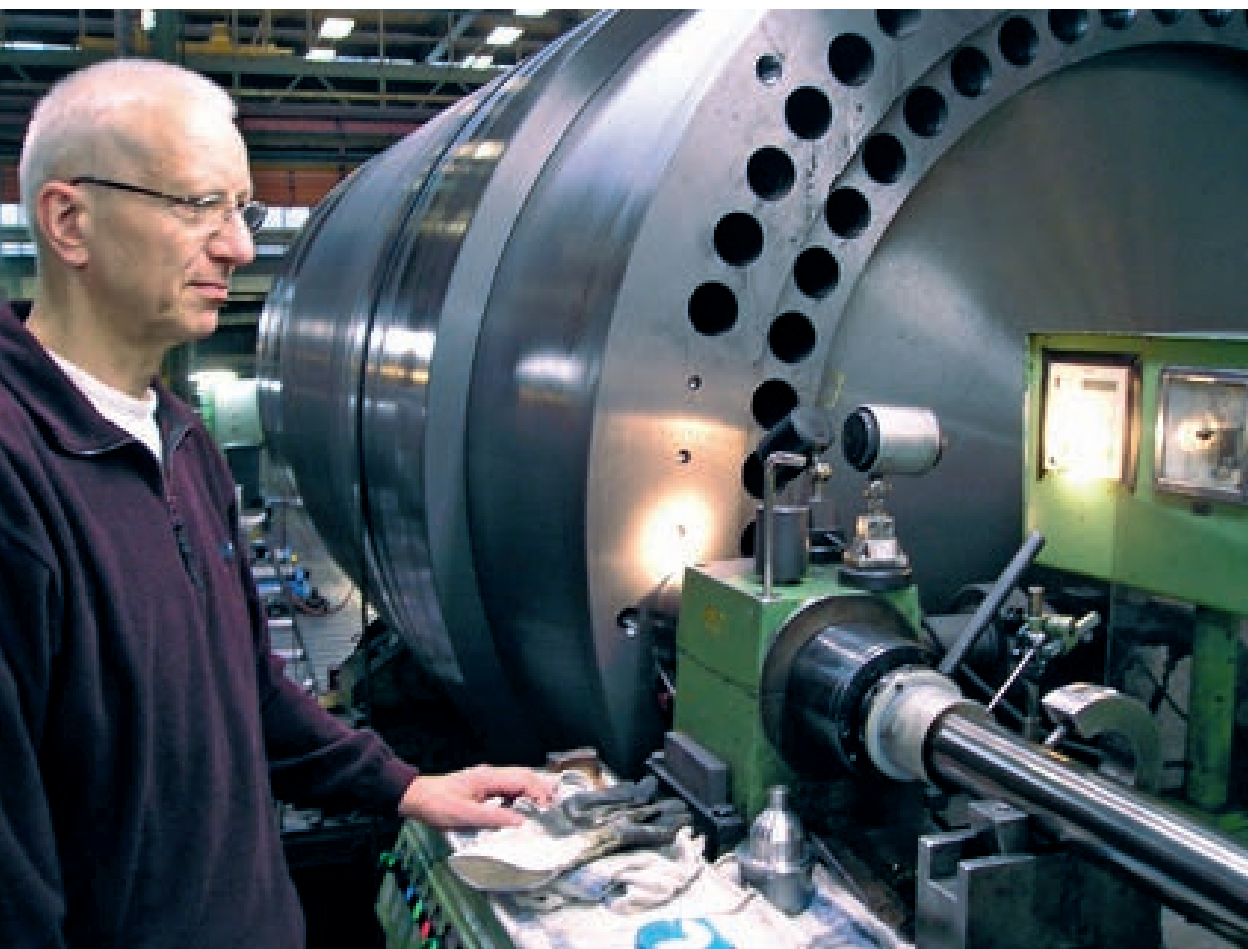
Tieflochbohrung an einem CASTOR®-Behäl- terkörper
