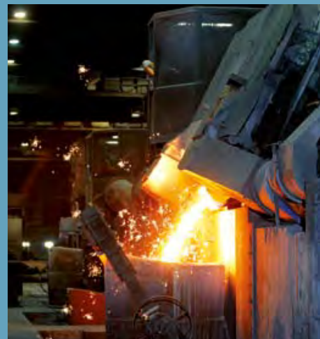
Rechts: Abstich: Abgabe des flüssigen Eisens aus dem Schmelzofen
