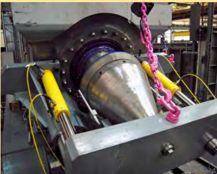
Walzenkappe während der Demontage
