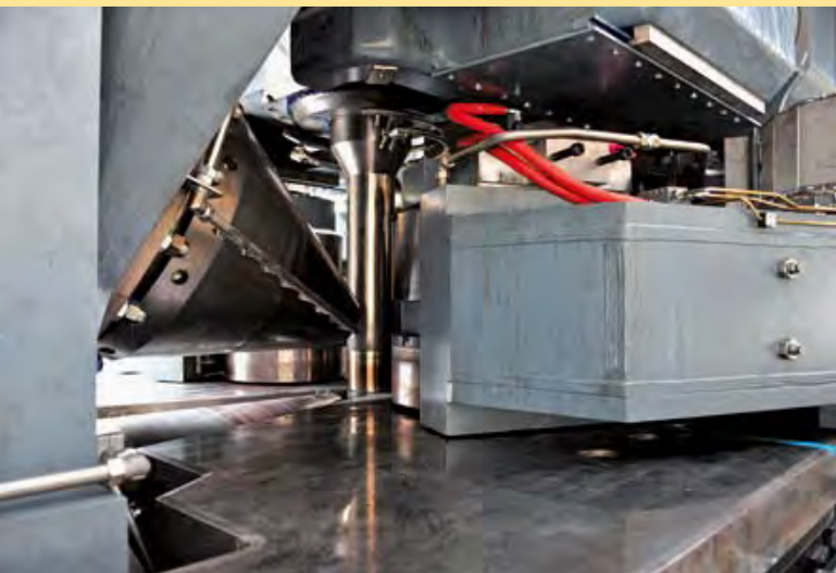
Waltztisch, linker Zentrierarm mit 200 mm Dorn-Durchmesser
