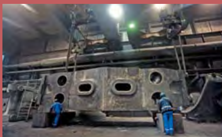
Links: Ausheben des Unterholms
