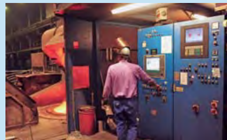
Modernste Induktionsöfen zum Schmelzen und Warmhalten des Flüssigeisens haben Einzug in den Schmelzbetrieb genommen
