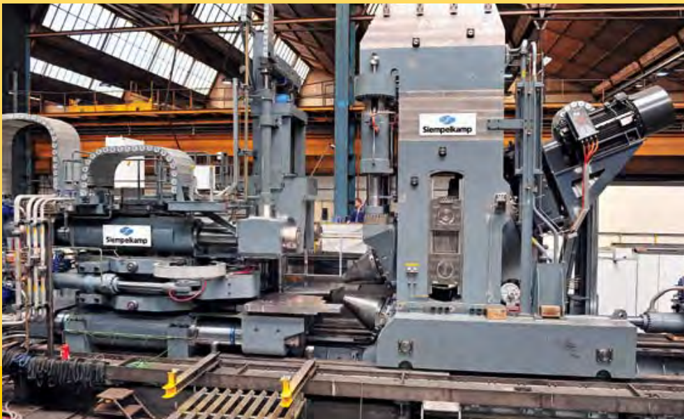
Ringwalze zur Abnahme bereit
