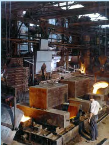
Die 60er Jahre in der Siempelkamp Giesserei: Kuppelöfen sind im Einsatz (zu sehen im Hintergrund des Gießaufbaus)
