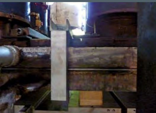
Klammer zur Fixierung der beiden Heizplatten
