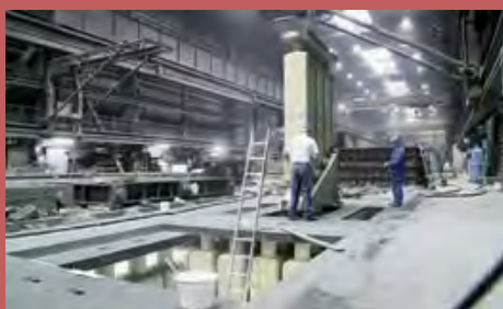
Formerei: Einsetzen der Kerne
