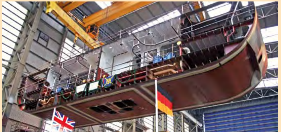
Bauteil eines Schiffes gefertigt in einer Sektion (Foto: Flensburger Schiffbau-Gesellschaft)
